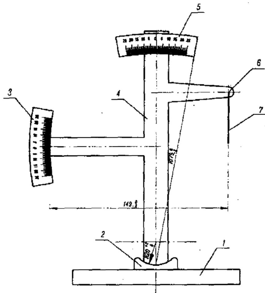
图4 雷氏夹膨胀测定仪
